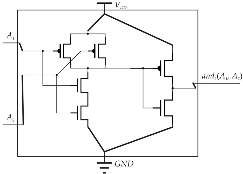
**Hinweis:** Überlegen Sie zunächst, welche CMOS-Schaltungen Sie bereits kennen und wie man  $and_2$  durch diese (eventuell durch Verknüpfung mehrerer) darstellen kann.
