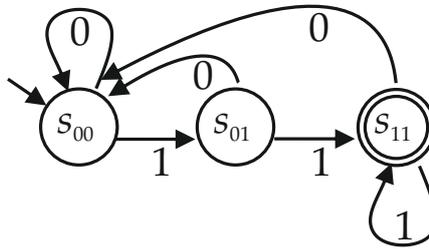
Ergänzen Sie das folgende unvollständige Schaltwerk so, dass es die Funktionsweise des EA  $A$  implementiert, d. h. dass genau dann eine 1 am Ausgang  $a$  anliegt, wenn sich der EA  $A$  nach Eingabe des über  $e$  erhaltenen Wortes im Endzustand befindet. Das ist immer dann der Fall, wenn die letzten beiden Bits der Eingabe 1 waren.
